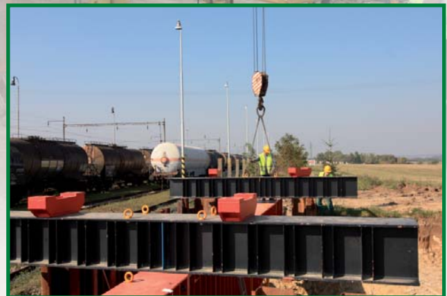
zatěžovací konstrukce pro max. sílu 5000 kN ukotvená do kotevnic pilot pomocí lan
