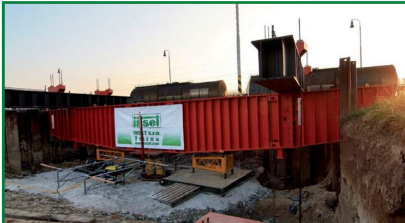
zatěžovací konstrukce pro max. sílu 5000 kN ukotvená do kotevnic pilot pomocí lan
